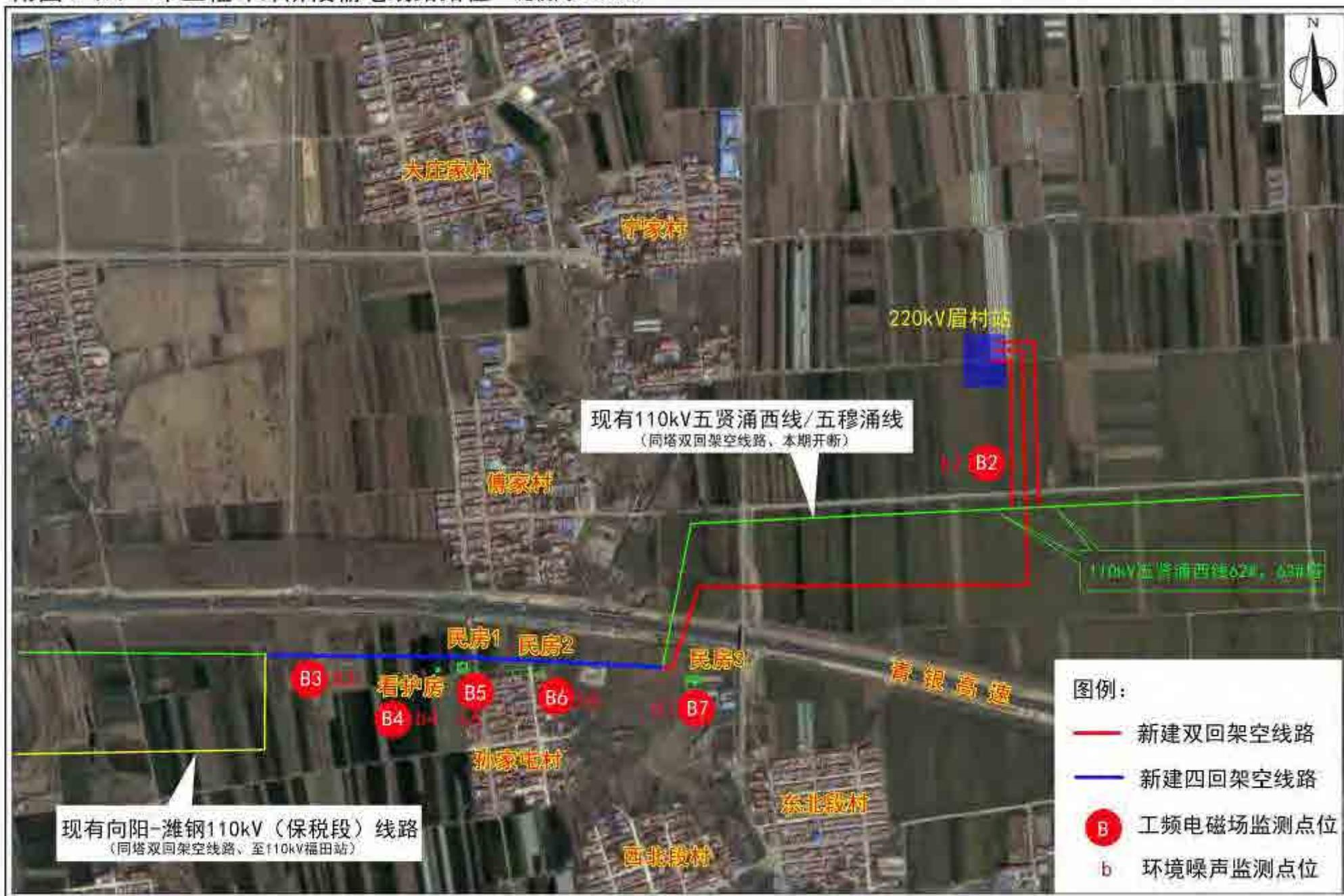
附图4 (b) 本工程环评阶段输电线路路径 比例尺1: 10000
