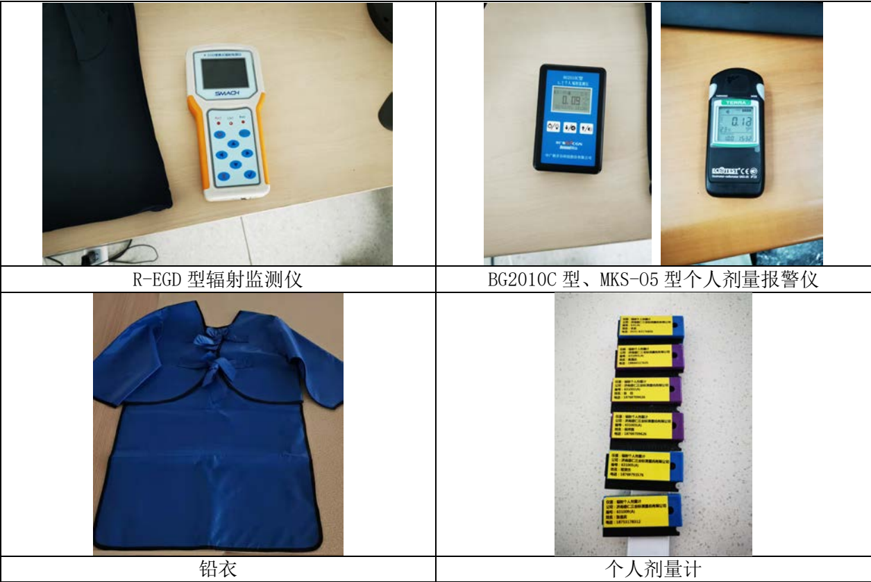
图 6-1 公司配备的辐射防护用品照片
