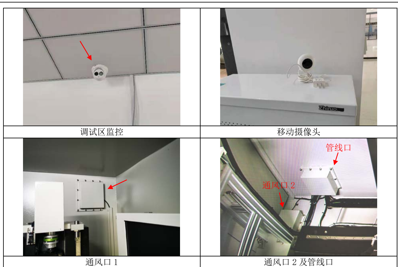
图 2-1（续） 本次验收 X 射线工业无损检测仪现场拍摄照片
