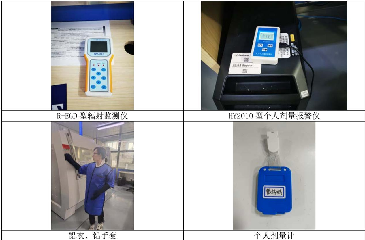
图 6-1 公司配备的辐射防护用品照片
