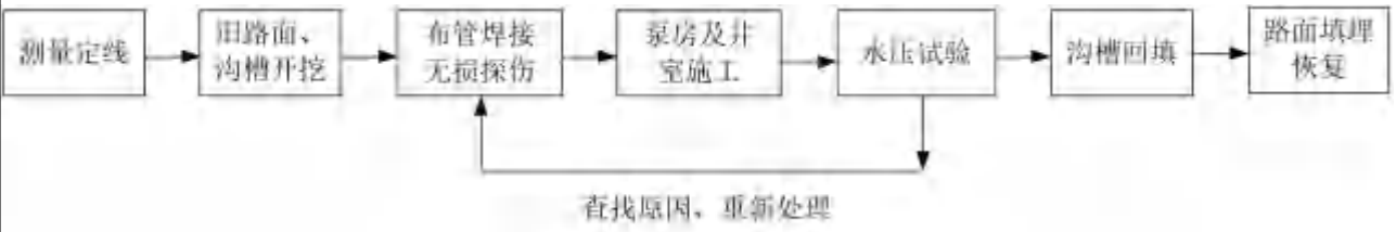
图 4-1 供热管网施工期流程
