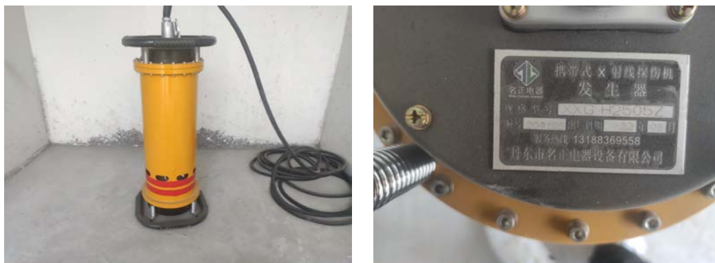
图 2-2 本项目配备的 X 射线探伤机
