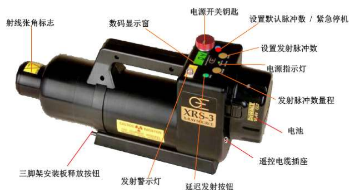
图 2-8 典型的 XRS-3 型脉冲 X 光机
