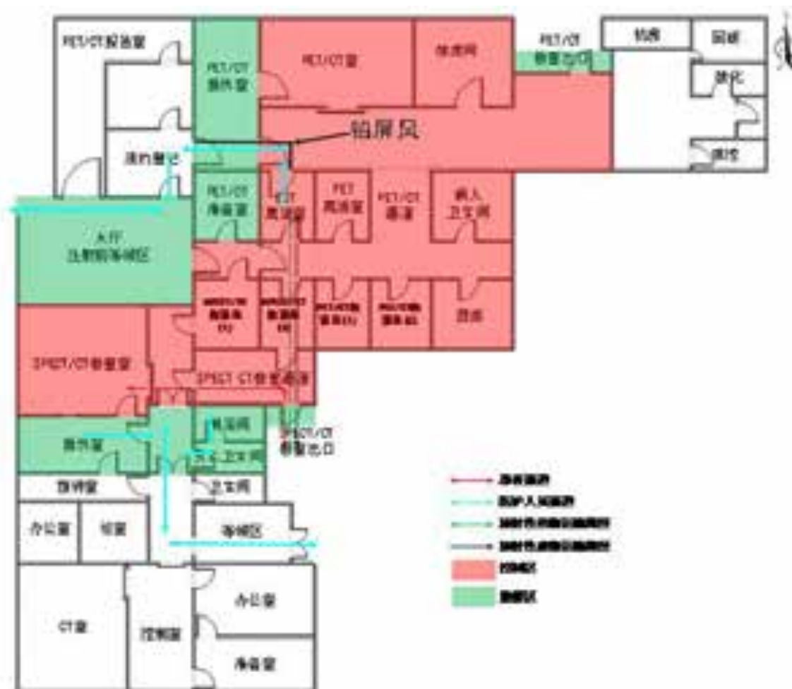
图 4-7 核医学科平面布置示意图(含场所分区及人流、物流路径)
