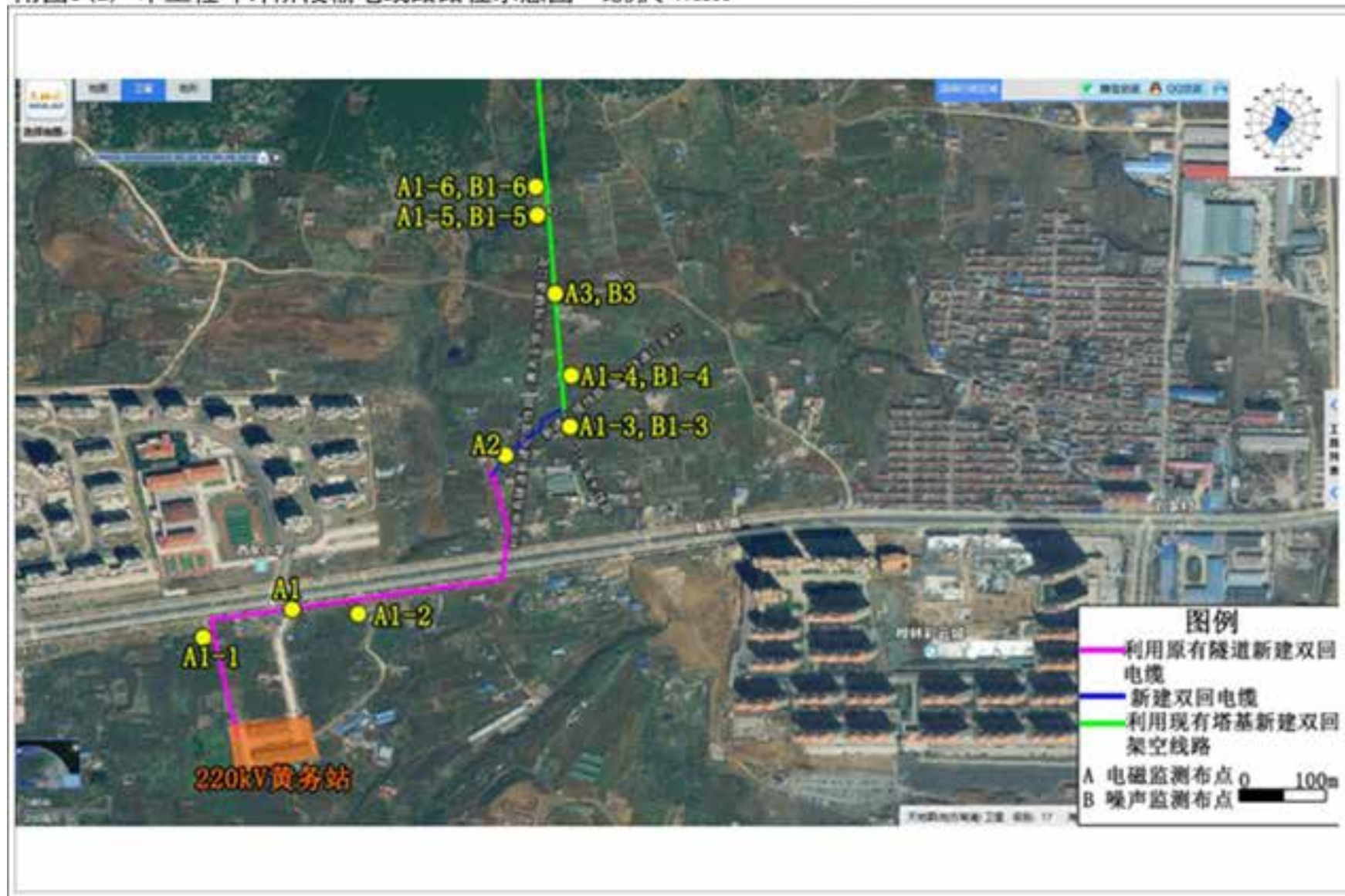
附图3(a) 本工程环评阶段输电线路路径示意图 比例尺 1:6500
