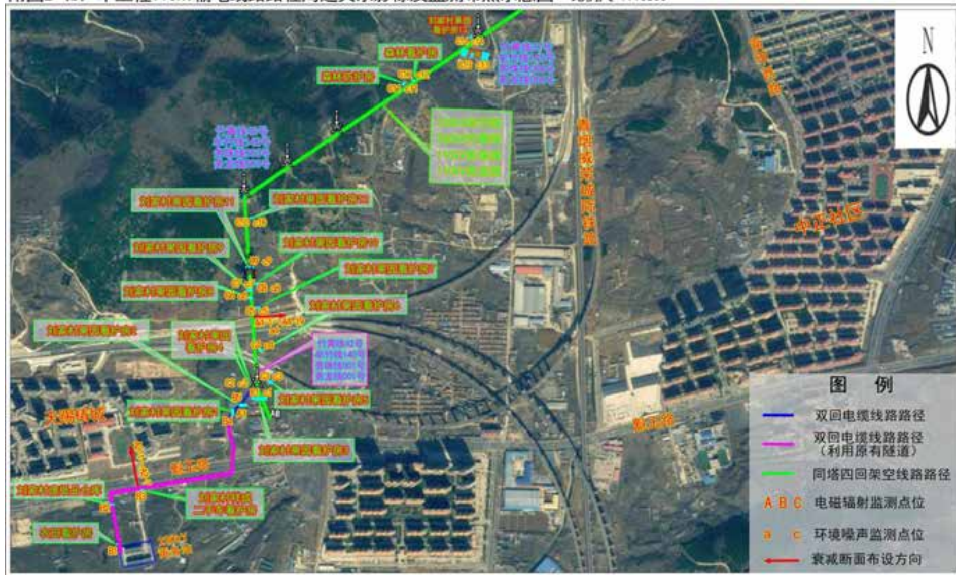
附图2 (b) 本工程110kV输电线路路径周边关系影像及监测布点示意图 比例尺 1:10800
