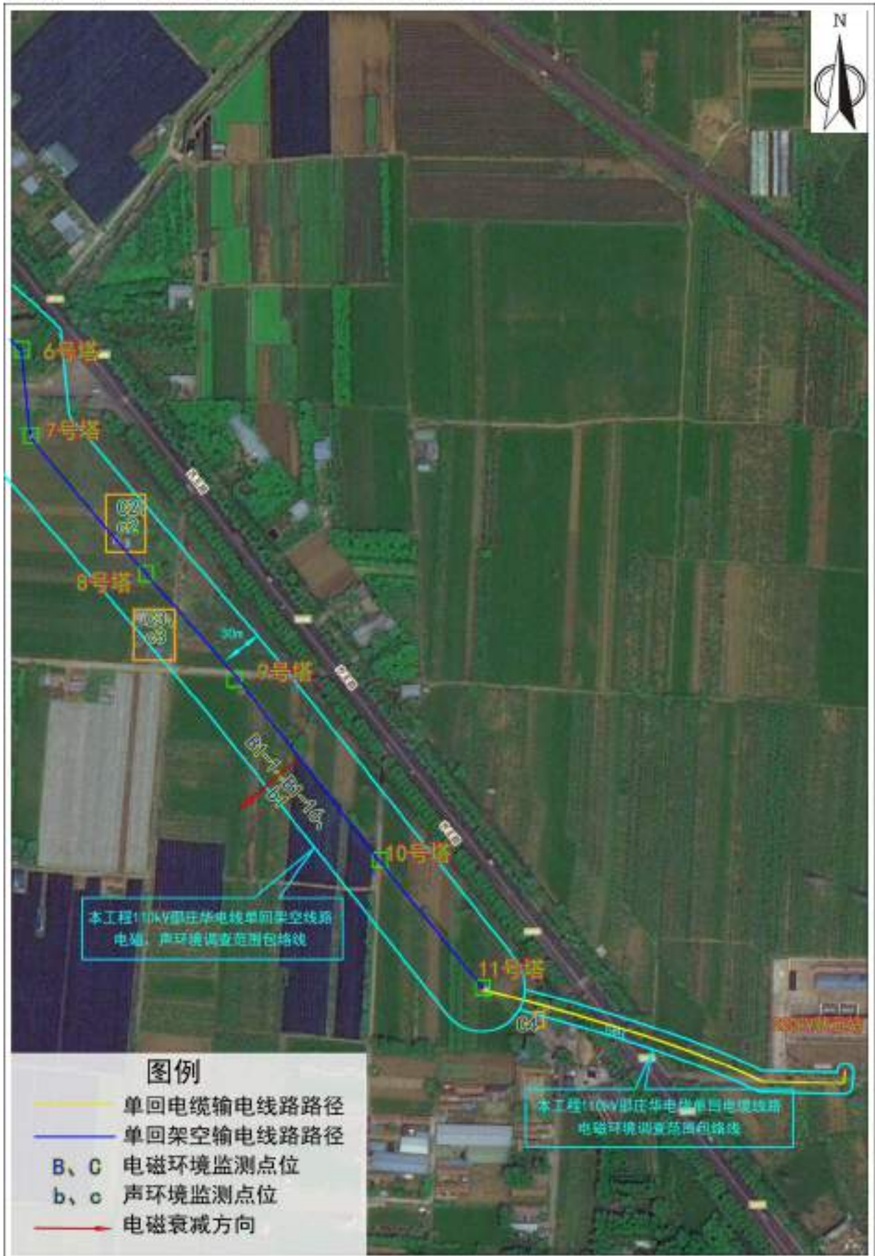
附图5 本工程输电线路路径周边关系影像及监测布点图 (b) 比例尺: 1:3800
