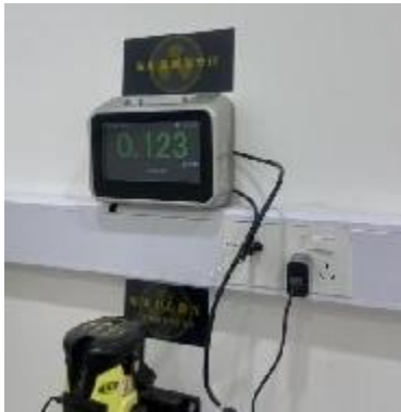
固定式辐射剂量率仪、射束中心激光
